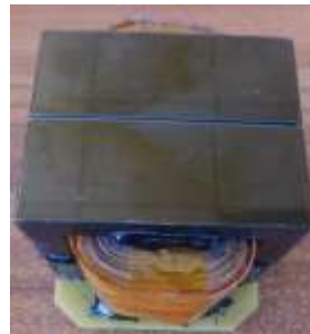
EE70*2 100mm*70mm*75mm 12KW 25A 500V
