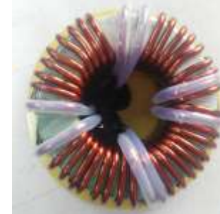
环形电感 T63 63mm*38mm*25mm
