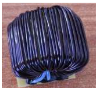
单相滤波电感 S200060*2 80mm*80mm*80mm 5KW 30A 220V
